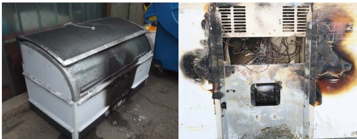
A hűtő és alsó része, ahol a meghibásodás bekövetkezett
