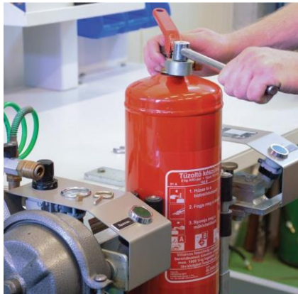
Fejszerelvény kitekerése CSAK NYOMÁSMENTES ÁLLAPOTBAN!
