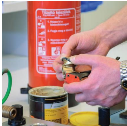
Új O-gyűrű felhelyezése minden karbantartáskor
