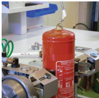
Tartály ellenőrzése tükrös tartályvizsgálóval
