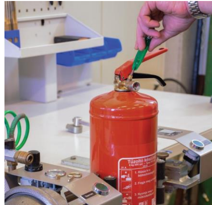
Készülék nyomásmentesítése a szelepbetét eltávolításával
