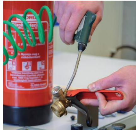
A fejszerelvény kifűvése sűrített levegővel
