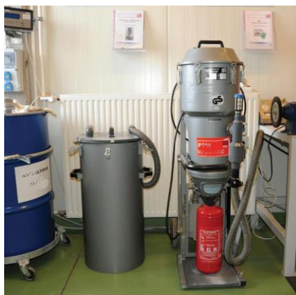
Porvisszatöltés zártrendszerű berendezéssel
