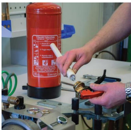
Felszállócső és nyomórugó kiemelése
