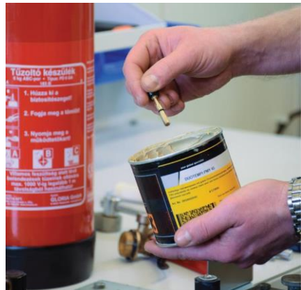
Szelepszár zsírozása, fejszerelvény összeszerelése
