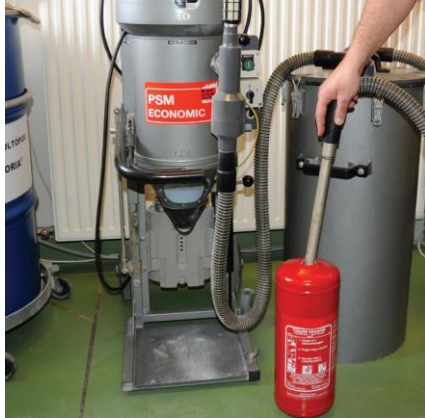
Porkiszívás zártrendszerű berendezéssel
