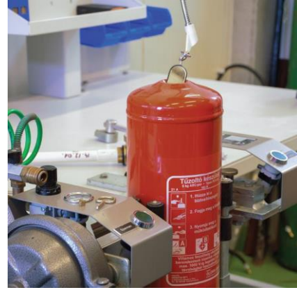
Tartály ellenőrzése tükrös tartályvizsgálóval
