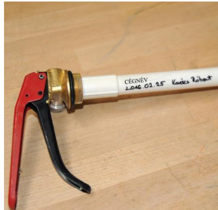
Felszállócső jelölése (dátum, karbantartó szervezet neve vagy azonosító jele, karbantartó személy aláírása)
