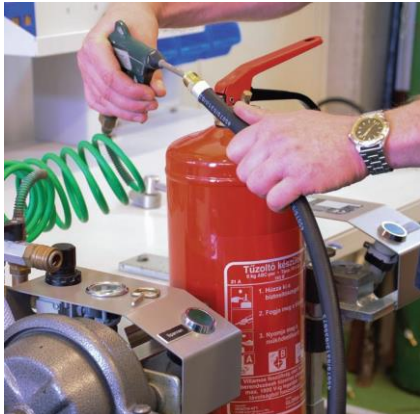
Tömlőszerelvény vizsgálata, kifűtatása sűrített levegővel
