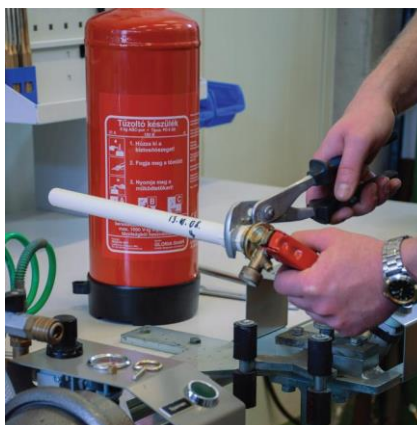
Felszállócső kitekerése a fejszerelvényből
