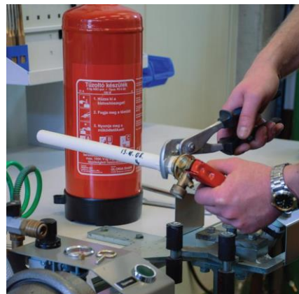
Felszállócső kitekerése a fejszerelvényből
