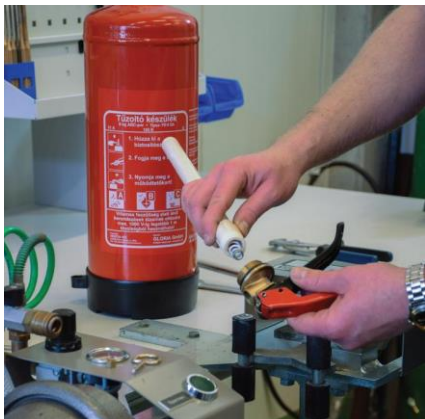
Felszállócső és nyomórugó kiemelése
