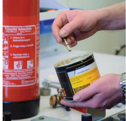
Szelepszár zsírozása, fejszerelvény összeszerelése
