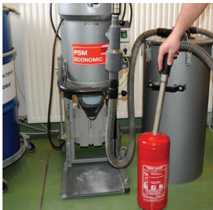
Porkiszívás zártrendszerű berendezéssel
