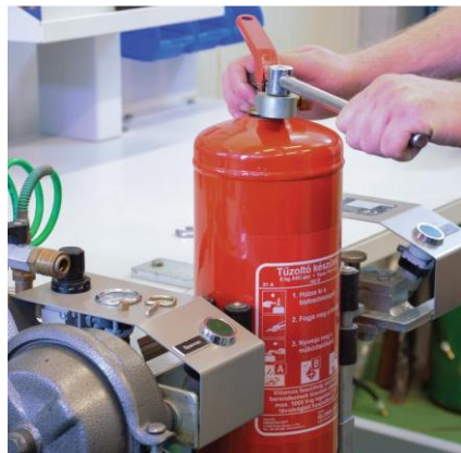
Fejszerelvény kitekerése CSAK NYOMÁSMENTES ÁLLAPOTBAN!
