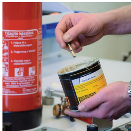
Szelepszár zsírozása, fejszerelvény összeszerelése
