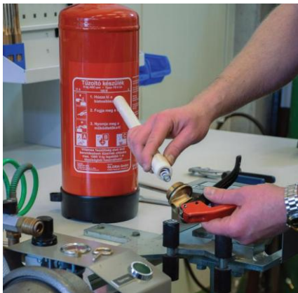
Felszállócső és nyomórugó kiemelése
