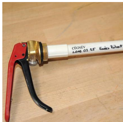
Felszállócső jelölése (dátum, karbantartó szervezet neve vagy azonosító jele, karbantartó személy aláírása)
