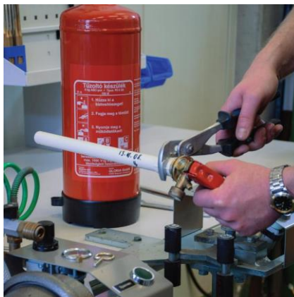
Felszállócső kitekerése a fejszerelvényből
