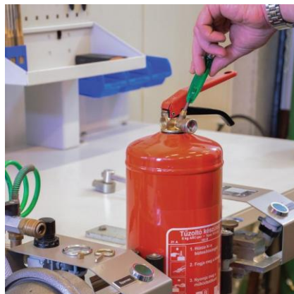
Készülék nyomásmentesítése a szelepbetét eltávolításával
