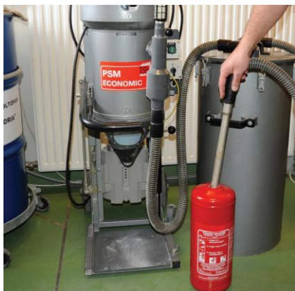
Porkiszívás zártrendszerű berendezéssel
