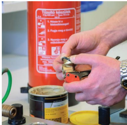
Új O-gyűrű felhelyezése minden karbantartáskor
