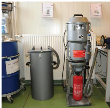
Porvisszatöltés zártrendszerű berendezéssel
