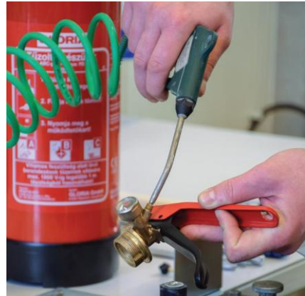
A fejszerelvény kifúvása sűrített levegővel
