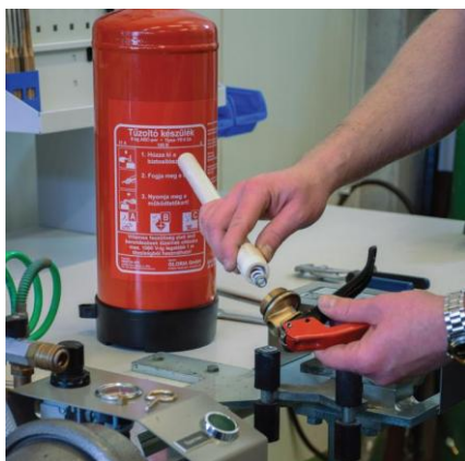
Felszállócső és nyomórugó kiemelése
