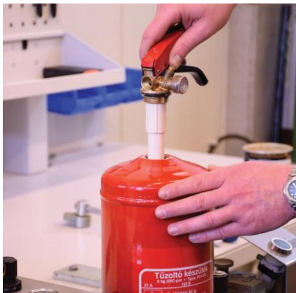
Komplett fejszerelvény függőleges behelyezése a tartályba
