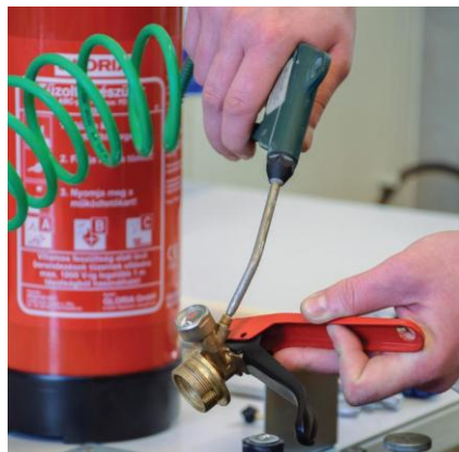
A fejszerelvény kifűvése sűrített levegővel
