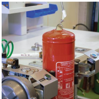
Tartály ellenőrzése tükrös tartályvizsgálóval
