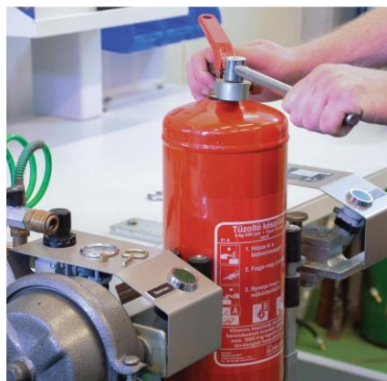
Fejszerelvény kitekerése CSAK NYOMÁSMENTES ÁLLAPOTBAN!
