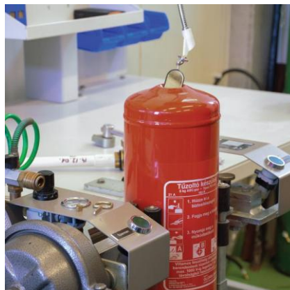
Tartály ellenőrzése tükrös tartályvizsgálóval
