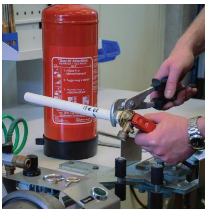
Felszállócső kitekerése a fejszerelvényből
