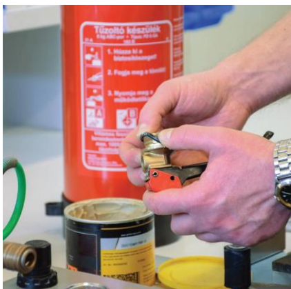
Új O-gyűrű felhelyezése minden karbantartáskor
