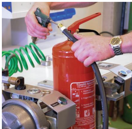
Tömlőszerelvény vizsgálata, kifűtatása sűrített levegővel
