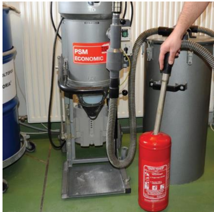
Porkiszívás zártrendszerű berendezéssel
