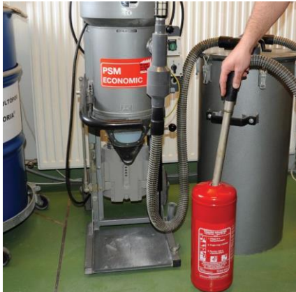
Porkiszívás zártrendszerű berendezéssel
