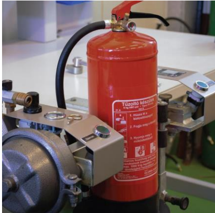
Készülék stabil rögzítése készülékbefogóval
