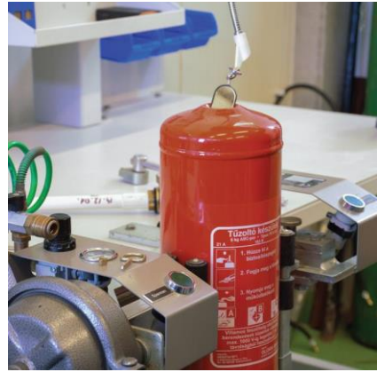
Tartály ellenőrzése tükrös tartályvizsgálóval
