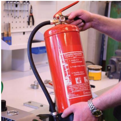
Karbantartott készülék végső szemrevételezése
