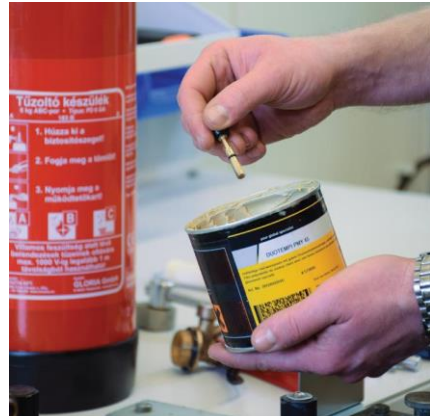
Szelepszár zsírozása, fejszerelvény összeszerelése
