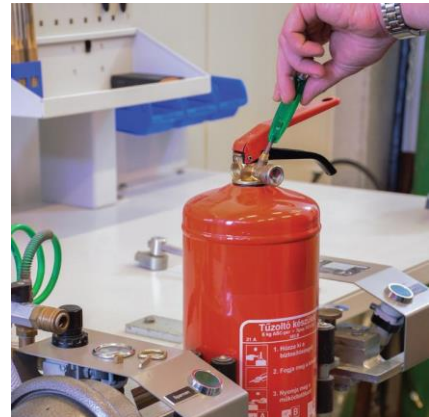
Készülék nyomásmentesítése a szelepbetét eltávolításával
