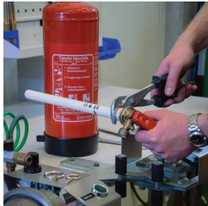
Felszállócső kitekerése a fejszerelvényből
