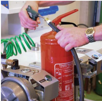
Tömlőszerelvény vizsgálata, kifűtése sűrített levegővel
