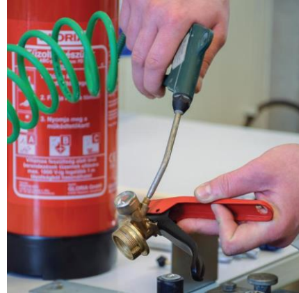
A fejszerelvény kifűvése sűrített levegővel
