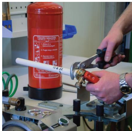
Felszállócső kitekerése a fejszerelvényből
