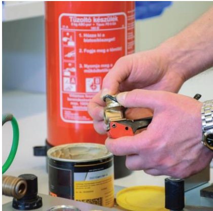
Új O-gyűrű felhelyezése minden karbantartáskor
