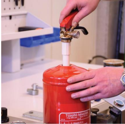
Komplett fejszerelvény függőleges behelyezése a tartályba
