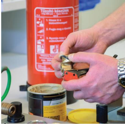
Új O-gyűrű felhelyezése minden karbantartáskor
