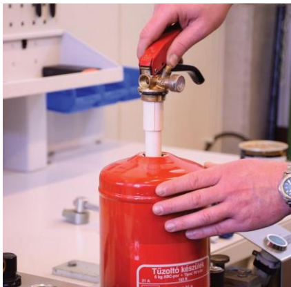
Komplett fejszerelvény függőleges behelyezése a tartályba
