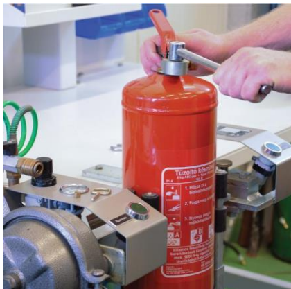
Fejszerelvény kitekerése CSAK NYOMÁSMENTES ÁLLAPOTBAN!
