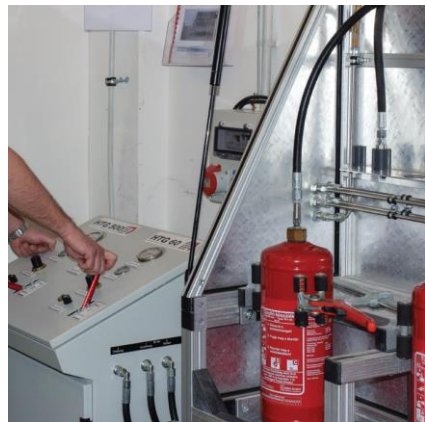
Tartályok nyomáspróbázása (a palástba beütött érték szerint)
