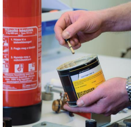
Szelepszár zsírozása, fejszerelvény összeszerelése
