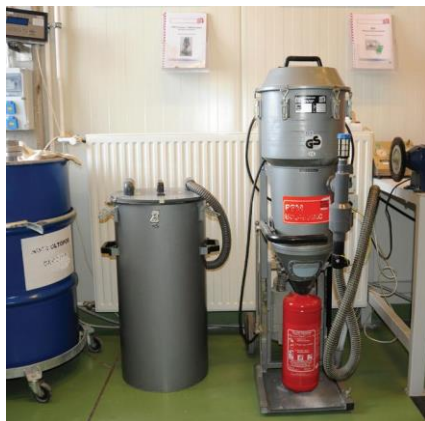
Porvisszatöltés zártrendszerű berendezéssel
