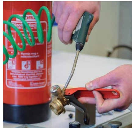
A fejszerelvény kifűvése sűrített levegővel
